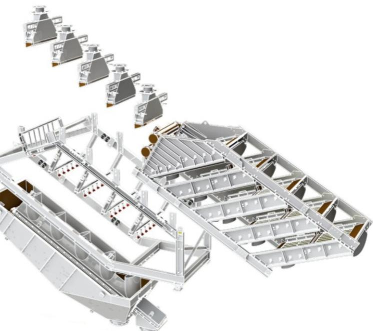
Грохот комплектуется полиуретановыми панелями, с коэффициентом «живого сечения» до 45%, обеспечивающие высокую удельную производительность. Типоразмер панелей от 45 мкм.
