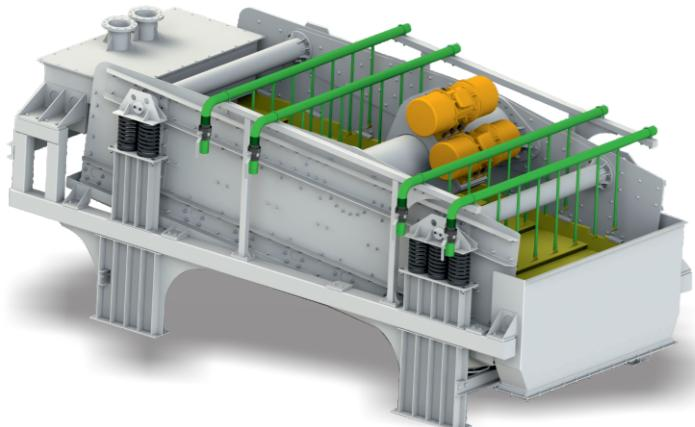
Высокочастотный Грохот SLL-7-16 WS лёгкого типа с линейными колебаниями предназначен для мокрого грохочения, обезвоживания и грохочения тонких классов. Форма просеивающей поверхности - Ступенчатая.
