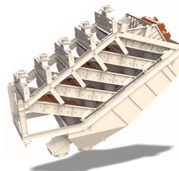
Грохот SFL-10-1.5x5W для мокрого грохочения мелких частиц, имеет высокую производительность и эффективность при минимальном занимаемом пространстве. Состоит из пяти отдельных дек, расположенных одна над другой и работающих параллельно.
